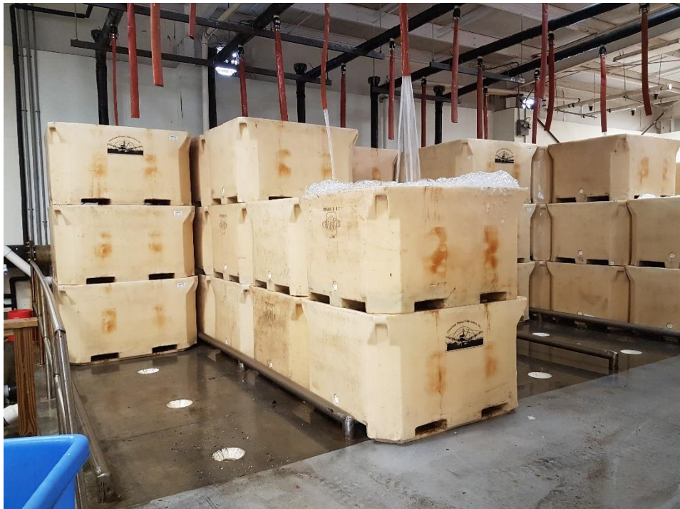
Figur 14: Eksempel på hvordan en landbasert oppbevaring av levende skjell kan se ut med kar som får tilført behandlet sjøvann
